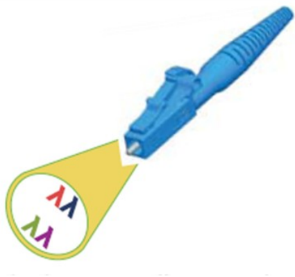
Gambar 7 Antarmuka teknologi WDM menggunakan panjang gelombang berbeda (berwarna) dari cahaya pada fiber optik tunggal (40GBASE-LR4, 100GBASE-LR4, dan 100GBASE-ER4) [3]
