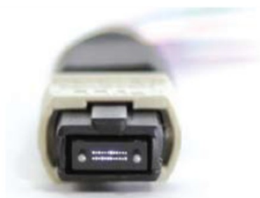
Gambar 6 Antarmuka 40GbE pada fiber optik multi-mode menggunakan 12-position konektor tipe MPO (40GBASE-SR4) [3]
