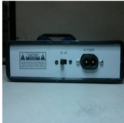
Gambar 4. Desain cover LAN Tester tampak sisi belakang
